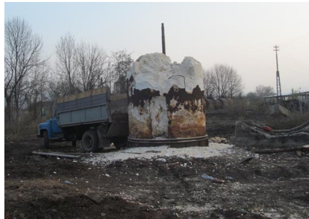
A szétbontott retorta, a megszilárdult tartalmával
